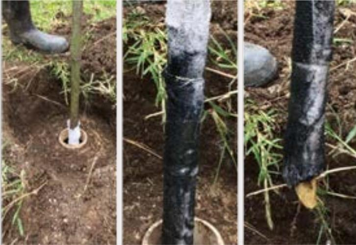
Proceso de verificación del nivel de lodos en un tanque séptico. Al introducir una vara con tela de paño amarrada en su extremo inferior. Los lodos se impregnan, distancia que se mide en la vara y compara con el nivel de líquidos en el tanque, como con la posición registrada para la boca inferior de la salida hacia el drenaje. E. Rosales E.
