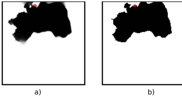
Figura 15.24: Comparación entre una cuenca calculada mediante el método FD8 (a) y otra aplicando el método D8 (b). Las celdas en color gris solo aportan parte de su flujo a la unidad hidrológica. El punto rojo señala el punto de cierre.
