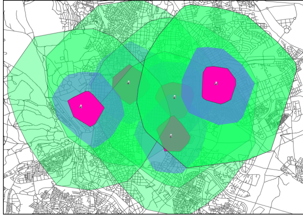
Figura 19.15: Zona de influencia de un punto considerando distancias sobre una red en lugar de distancia euclídea.
