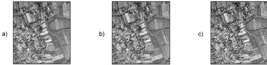
Figura 6.21: Efectos de la utilización de algoritmos de compresión con pérdidas. a) Imagen original. b) Imagen almacenada mediante compresión con pérdidas. c) Imagen tras diez procesos de lectura y almacenamiento en un formato de archivo con compresión con pérdidas. El efecto de la degradación sucesiva que la imagen sufre es claramente apreciable.
