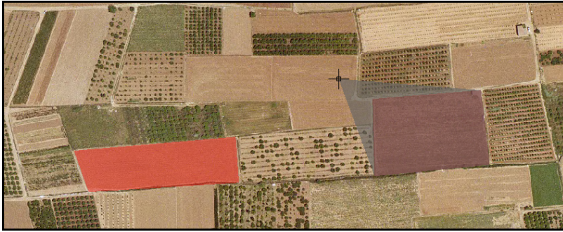
Figura 6.10: Corrección de entidades con las funciones de edición de un SIG. El polígono de la derecha se encuentra en edición, siendo modificado uno de sus vértices.
