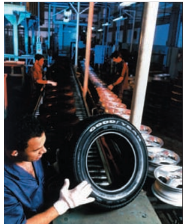
Un socio de Goodyear inspecciona una llanta radial en la fábrica de Sao Paulo, Brasil, antes de montarla en la rueda. Goodyear practica inspecciones visuales e internas de las llantas, incluso saca llantas de la línea de producción para pasarlas por rayos X. Los ingenieros de control de calidad cortan al azar periódicamente ciertas llantas para estudiar varios detalles que puedan afectar el rendimiento, el viaje o la seguridad.
